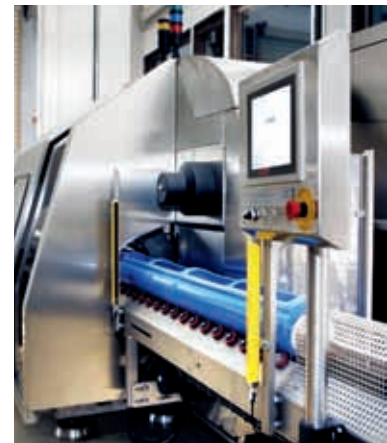
Figuur 1. p-T-diagram van factor 10^5 inactivering van geselecteerde cellijnen (links), NC Hyperbaric 600 MPA, 55 liter hogedruk machine van het DIL, opgesteld in de testfaciliteit van het DIL (rechts).
