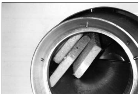
Een Lutetia-ontdooitumbler voor diepgevroren blokken seafood. Als voorbeeld calamar. Een Lutetia type 40 tumbler kan 1.400 kg inktvisringen in blokken van 12 kg in drie uur verwerken, met een eindtemperatuur van 1°C.
