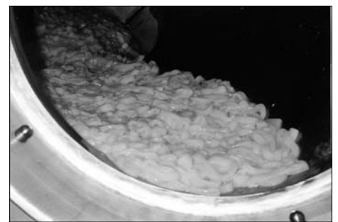
Een Lutetia-ontdooitumbler voor diepgevroren blokken seafood. Als voorbeeld calamar. Een Lutetia type 40 tumbler kan 1.400 kg inktvisringen in blokken van 12 kg in drie uur verwerken, met een eindtemperatuur van 1°C.
